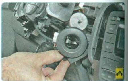
6. Снимите антенный блок.
