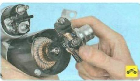
5. Перед установкой щеткодержателя на якорь разведите щетки и зафиксируйте любым доступным способом (например, подходящей оправкой).
