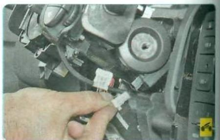
5. Отожмите фиксатор и отсоедините от антенного блока иммобилизатора колодку жгута проводов.
