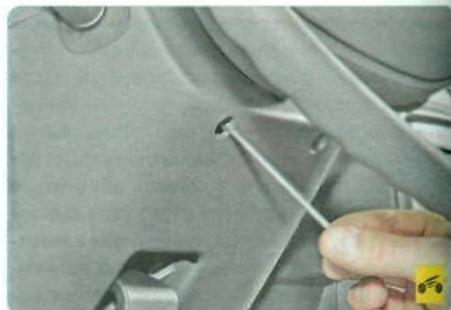
2. Выверните два болта, соединяющие верхнюю и нижнюю части кожуха рулевой колонки.
