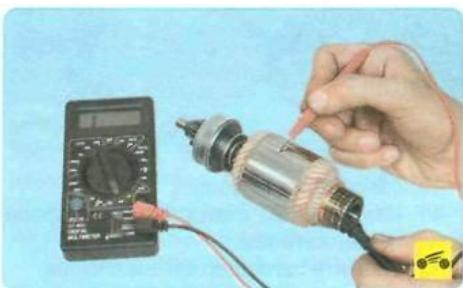
18. На шлицах и цапфах вала якоря не должно быть повреждений (забоины и заиды). Коллектор якоря не должен иметь следов обгорания. Незначительное обгорание устранит ветошью, смоченной в бензине, и мелкозернистой наждачной шкуркой. Проверьте обмотку якоря на короткое замыкание с помощью омметра. Сопротивление должно стремиться к бесконечности.
