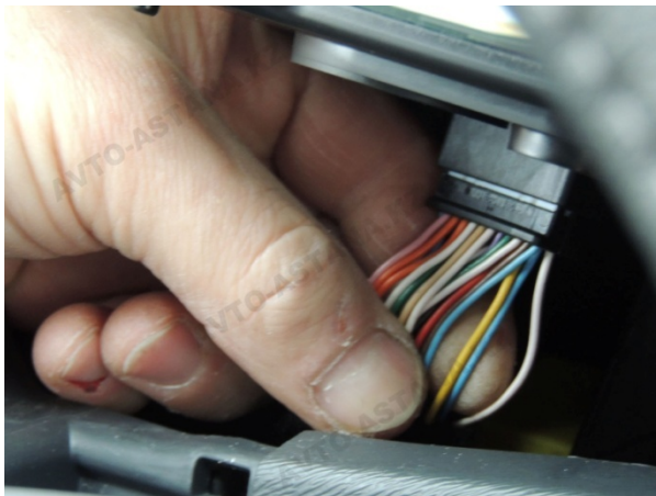
Фото 8. Подключаем желтый провод шлейфа к контакту №10
