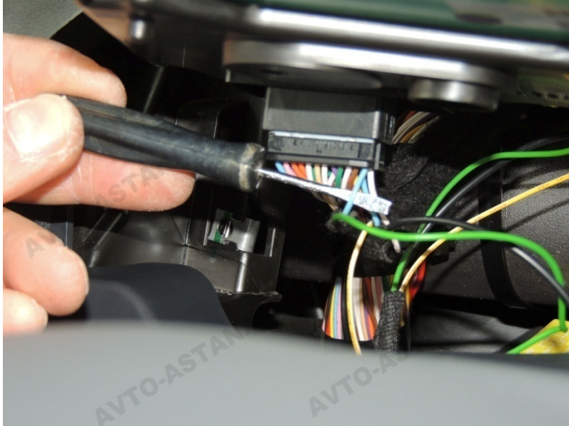
Фото 9. Подключаем зеленый провод к контакту №24
