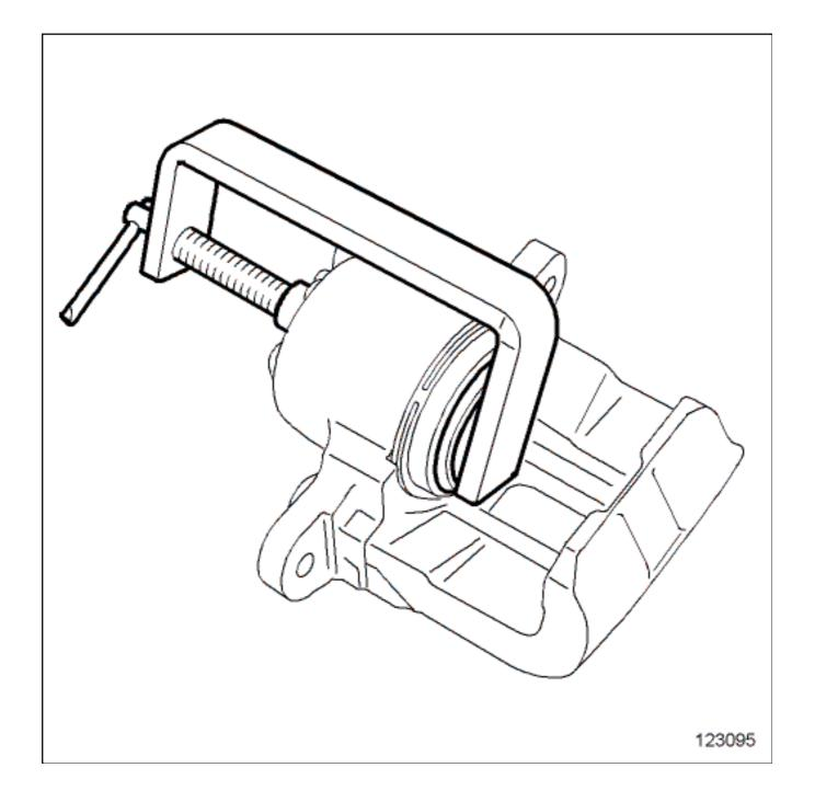
Переместите поршень до упора внутрь цилиндра (предварительно нанеся на него смазку из состава ремкомплекта) с помощью приспособленияПриспособление для перемещения поршня внутрь рабочего цилиндра переднего тормоза(Fre. 1842).
