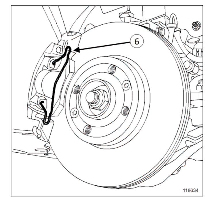
□ Снимите пружину (5).
