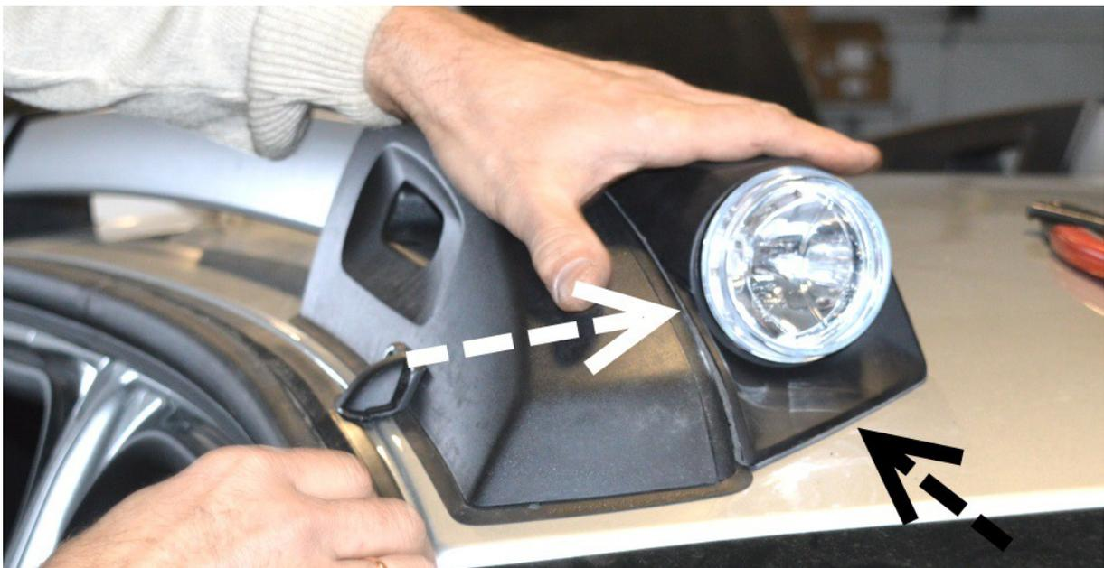
20. В точках крепления корпуса фонарей к накладке рейлинга проделать тонким шилом отверстия в накладках (можно использовать сверло 2-2,5мм). Закрепить каждый корпус двумя саморезами под «звездочку» из комплекта.
