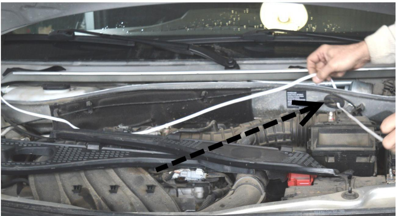
14. Продеть двойные провода в просверленные в накладках рейлингов отверстия во внутреннюю сторону рейлингов, надеть изолированные клеммы на концы проводов, обжать плоскогубцами.
