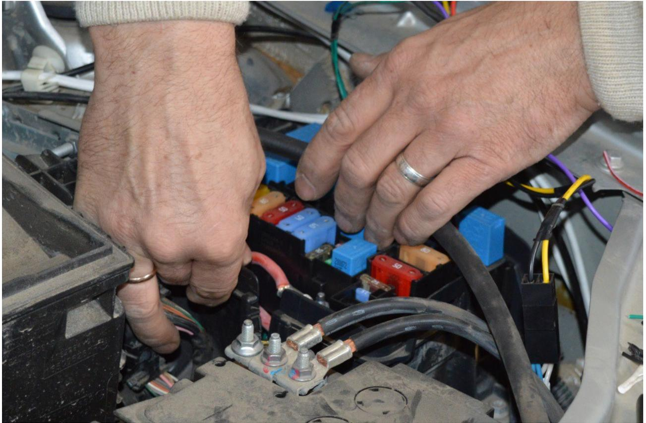
2. Через боковую крышку блока предохранителей проложить провода с клеммами к аккумулятору (предохранитель остается внутри блока).
