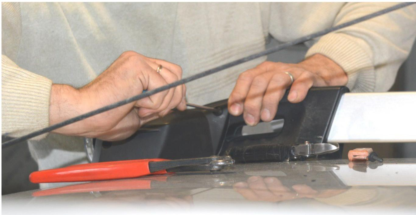
**При закручивании саморезов нормируйте усилие, старайтесь не перетянуть, т. к. губчатая эластичная прокладка от чрезмерной затяжки деформируется, и примыкающая к крыше поверхность фонаря может образовать щель между корпусом фонаря и плоскостью крыши.**
