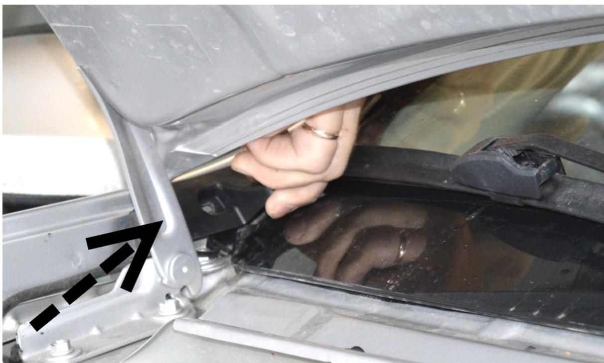
11. Частично снять резиновый профиль-уплотнитель с отбортовки крыши над передними дверьми. Просверлить насквозь передние пластиковые накладке рейлингов сверлом М8 (длина сверла не менее 100мм). Координаты центров отверстий — 130мм от переднего края, 12мм от нижнего края наружной пластиковой накладки рейлинга.
