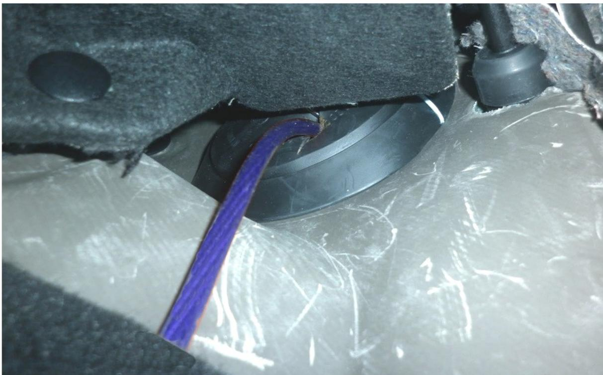
5. Заправить синий провод под верхний край напольного покрытия над педалями до кожуха рычага коробки передач.
