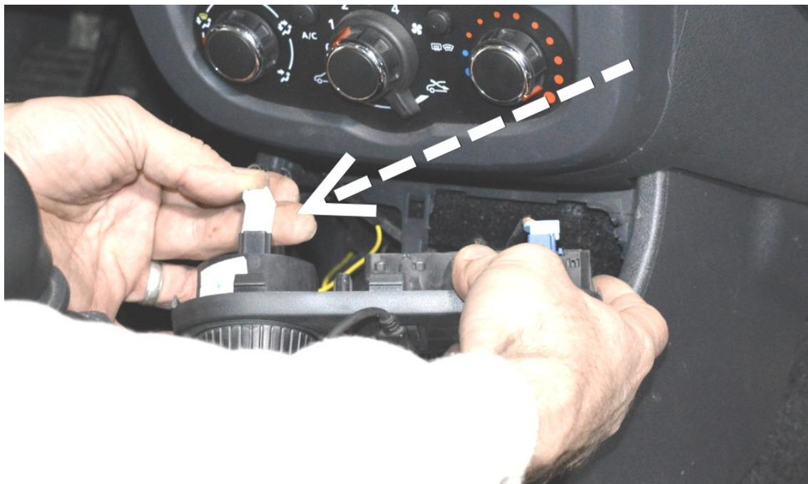
Для переднеприводных автомобилей- снять короб-заглушку, подключение произвести к проводам жгута управления климатом.
