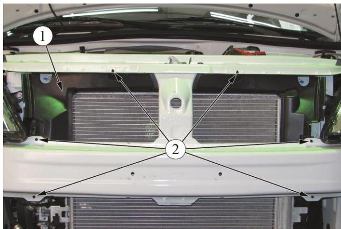
Рисунок 5-1 – Снятие воздухоотражателя:
