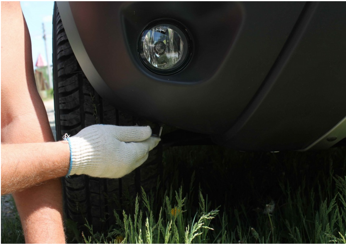
Нижний крайний саморез крепления бампера
