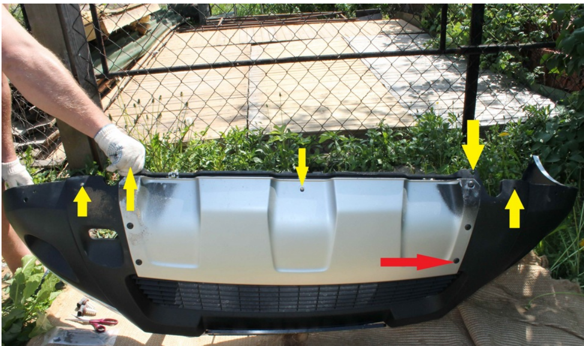
Места крепления нижней части бампера Беляша отмечены жёлтыми стрелками
