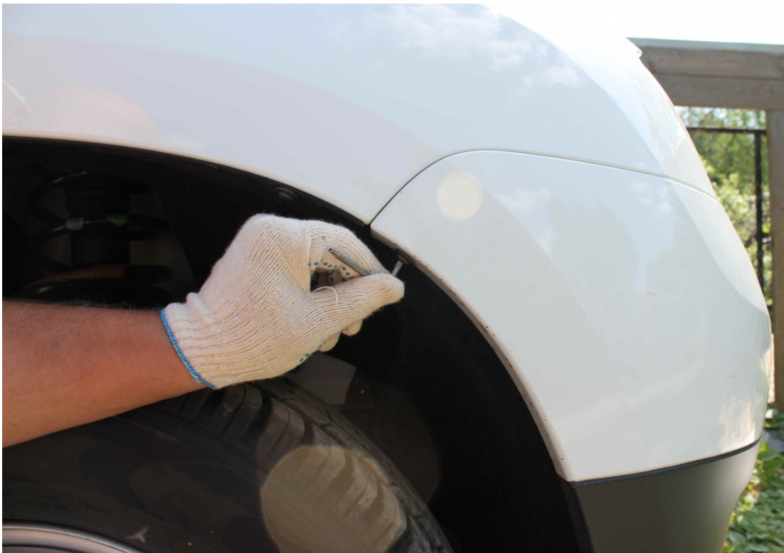
Боковой крайний саморез крепления бампера
