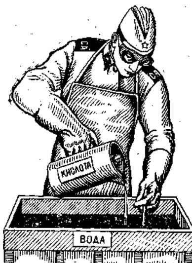
Рис. 34. Приготовление электролита
