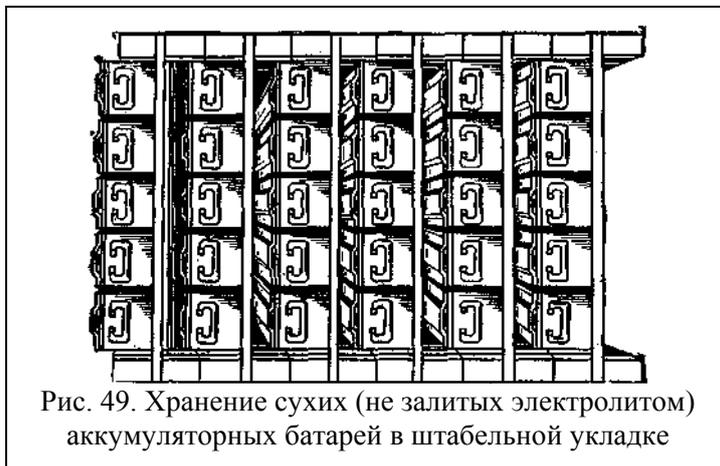
Рис. 49. Хранение сухих (не залитых электролитом) аккумуляторных батарей в штабельной укладке
