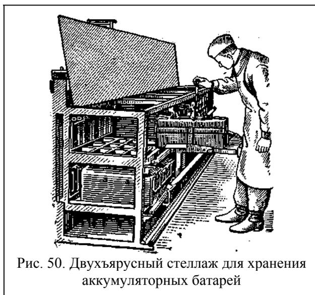
Рис. 50. Двухъярусный стеллаж для хранения аккумуляторных батарей
