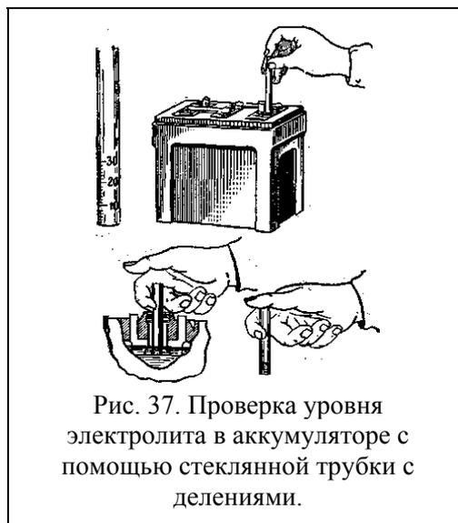
Рис. 37. Проверка уровня электролита в аккумуляторе с помощью стеклянной трубки с делениями.
