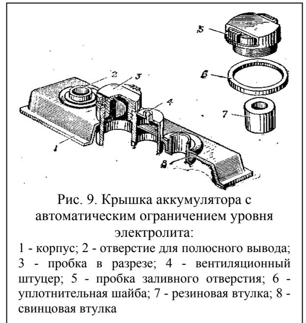
Рис. 9. Крышка аккумулятора с автоматическим ограничением уровня электролита:
