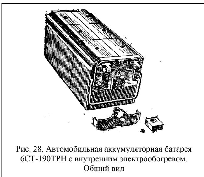
Рис. 28. Автомобильная аккумуляторная батарея 6СТ-190ТРН с внутренним электрообогревом.
