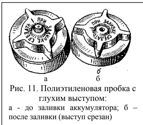
Рис. 11. Полиэтиленовая пробка с глухим выступом:
