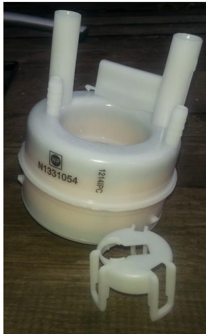
сменный модуль (код виден) еще такой реферанс на фильтр есть, JAPAN PARTS FC-130S.
