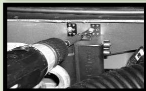
**Внимание:** При установке на тяжелый грузовой автомобиль или автобус кронштейн должен быть закреплен сверху и снизу с использованием всех четырех винтов.
