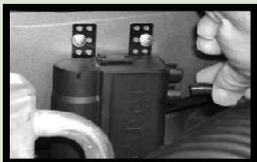
**Предупреждение:** немного жидкости может вытечь из устройства, когда Вы удалите желтые колпачки. Устройство было заполнено стандартной моющей жидкостью для предотвращения каких либо повреждений во время первоначальной установки.
