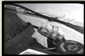
7. Используя правильный размер ключа, подсоедините круглый терминал черного силового кабеля к любой металлической части автомобиля которая является корпусом. Это соединение должно быть свободно от краски и ржавчины.
