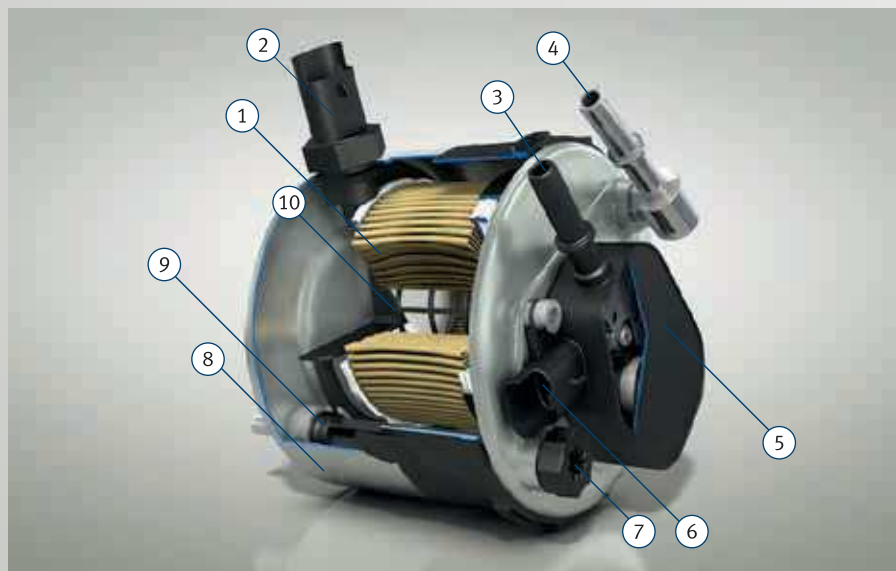
Устройство топливного фильтра
