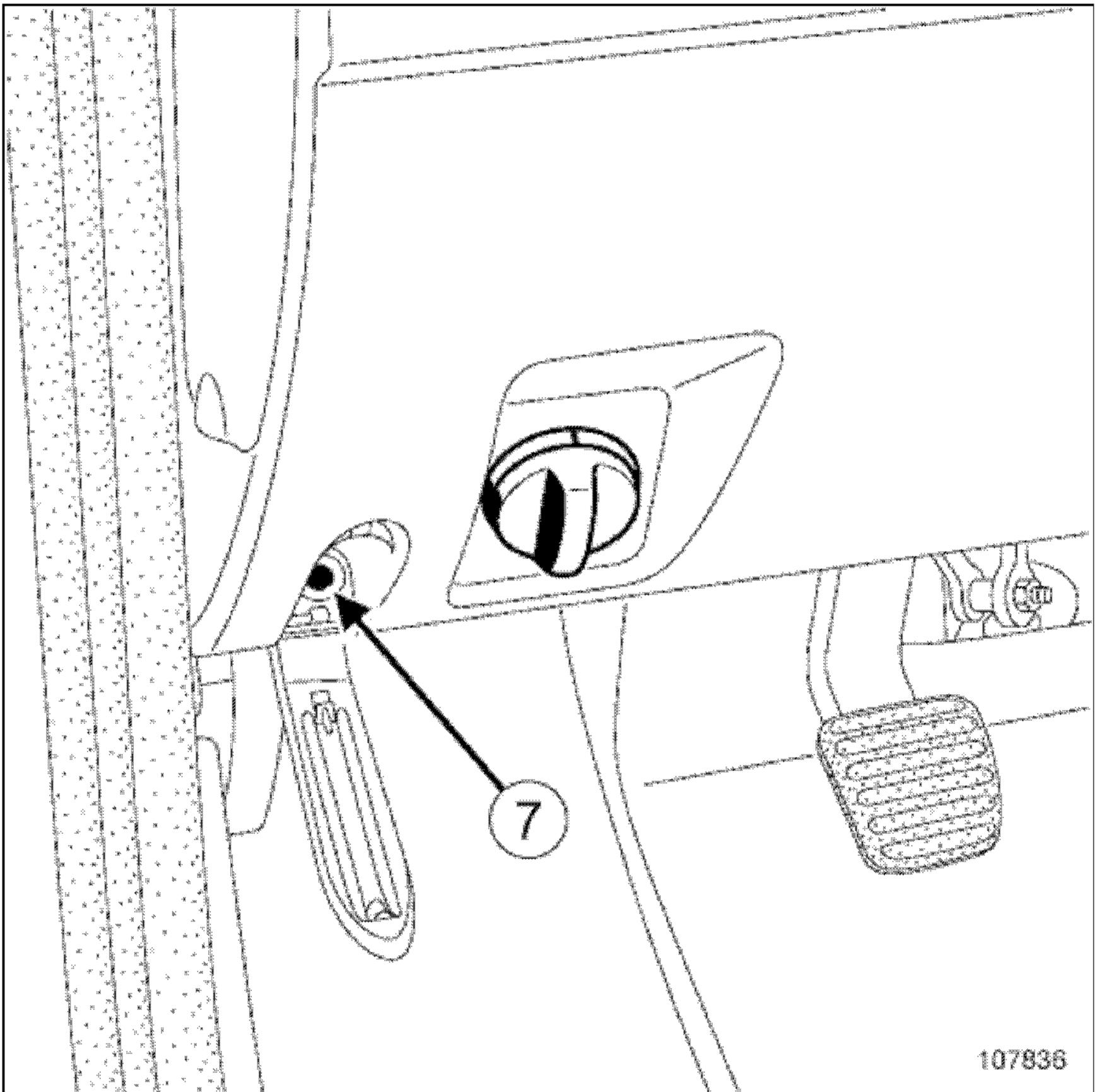
Снимите болты (7) крепления с каждой стороны приборной панели.
