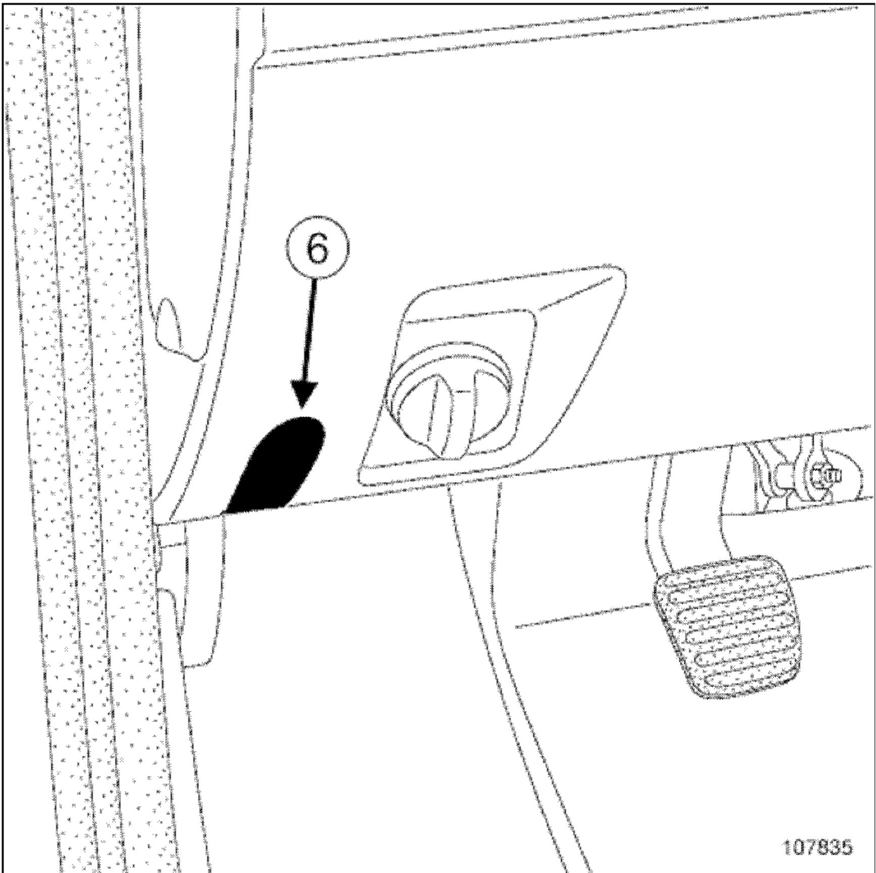
Снимите заглушки(6) с каждой стороны приборной панели.
