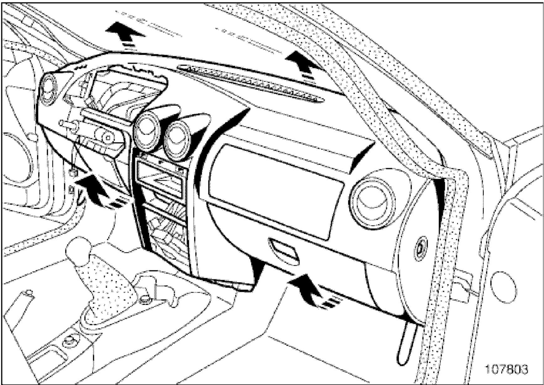
Снимите часть приборной панели (эта операция выполняется вдвоем с помощником).
