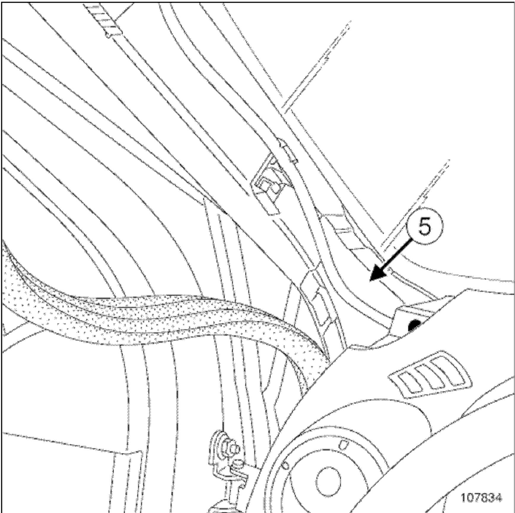
Снимите болты (5) крепления с каждой стороны приборной панели.
