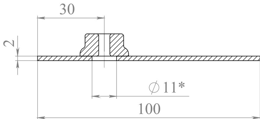
Гайка М10 (сварка)
