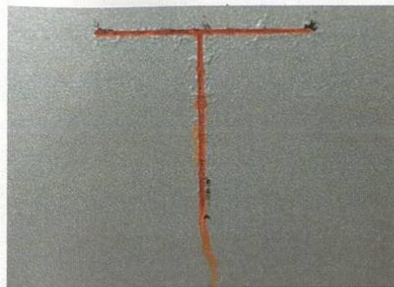
В тарированных надрезах краски на всех кузовных панелях продолжает развиваться коррозия
