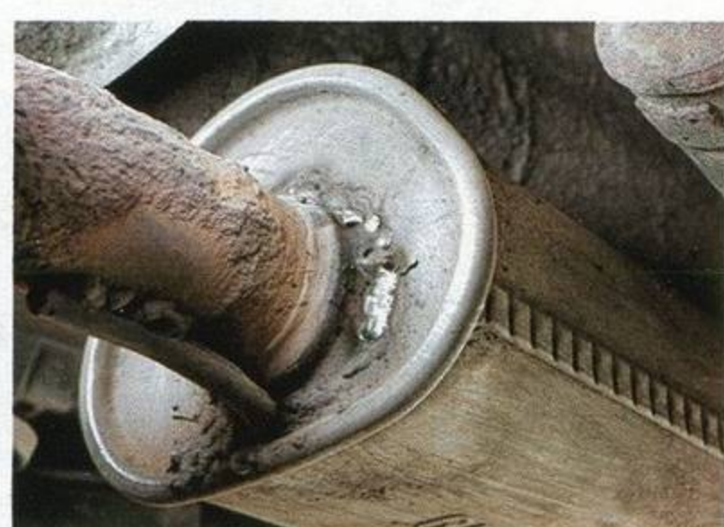
От тряски на Ниве разрушилось соединение выхлопной трубы и корпуса глушителя
