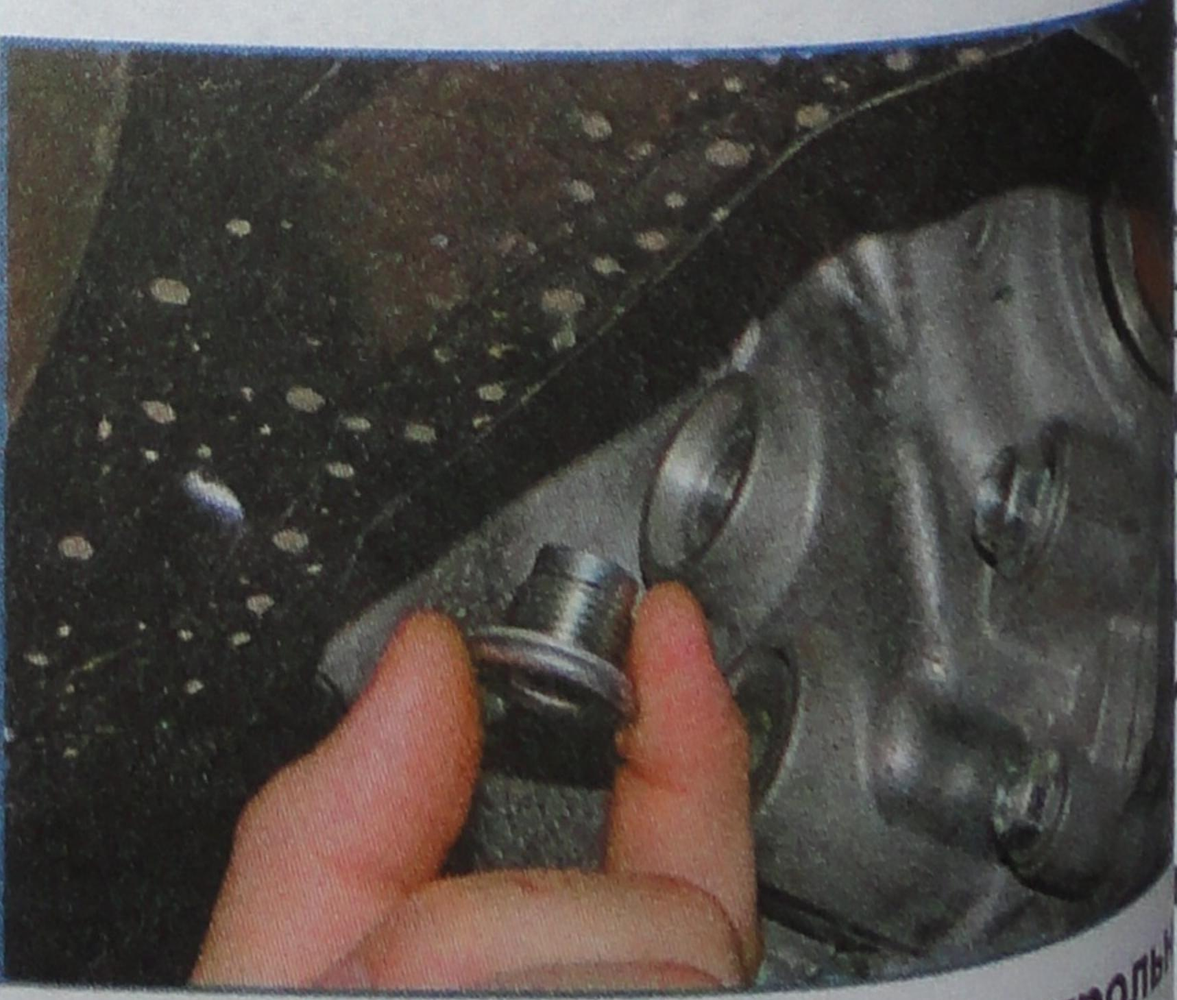
...и вынимаем пробку контрольного отверстия.
