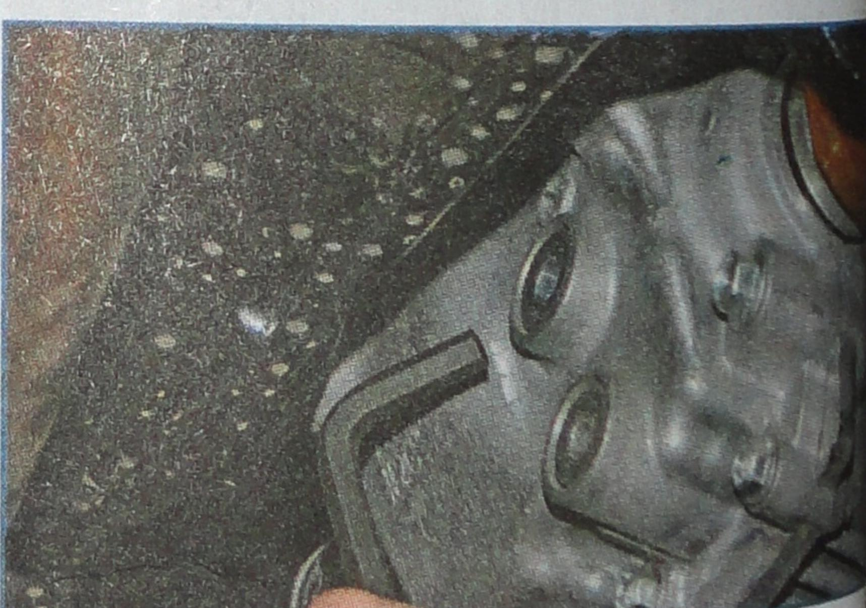
Шестигранником «на 10» отворачиваем пробку сливного отверстия...
