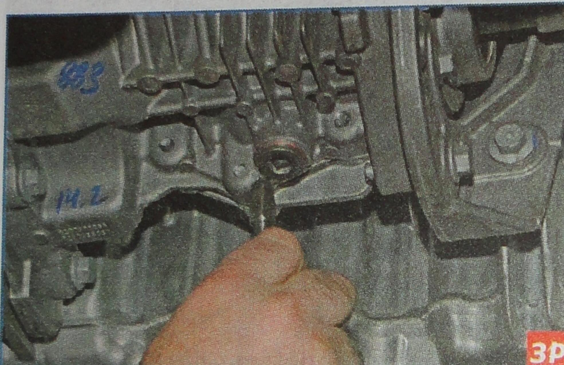
Четырехгранныком «на 8» отворачиваем пробку сливного отверстия...
