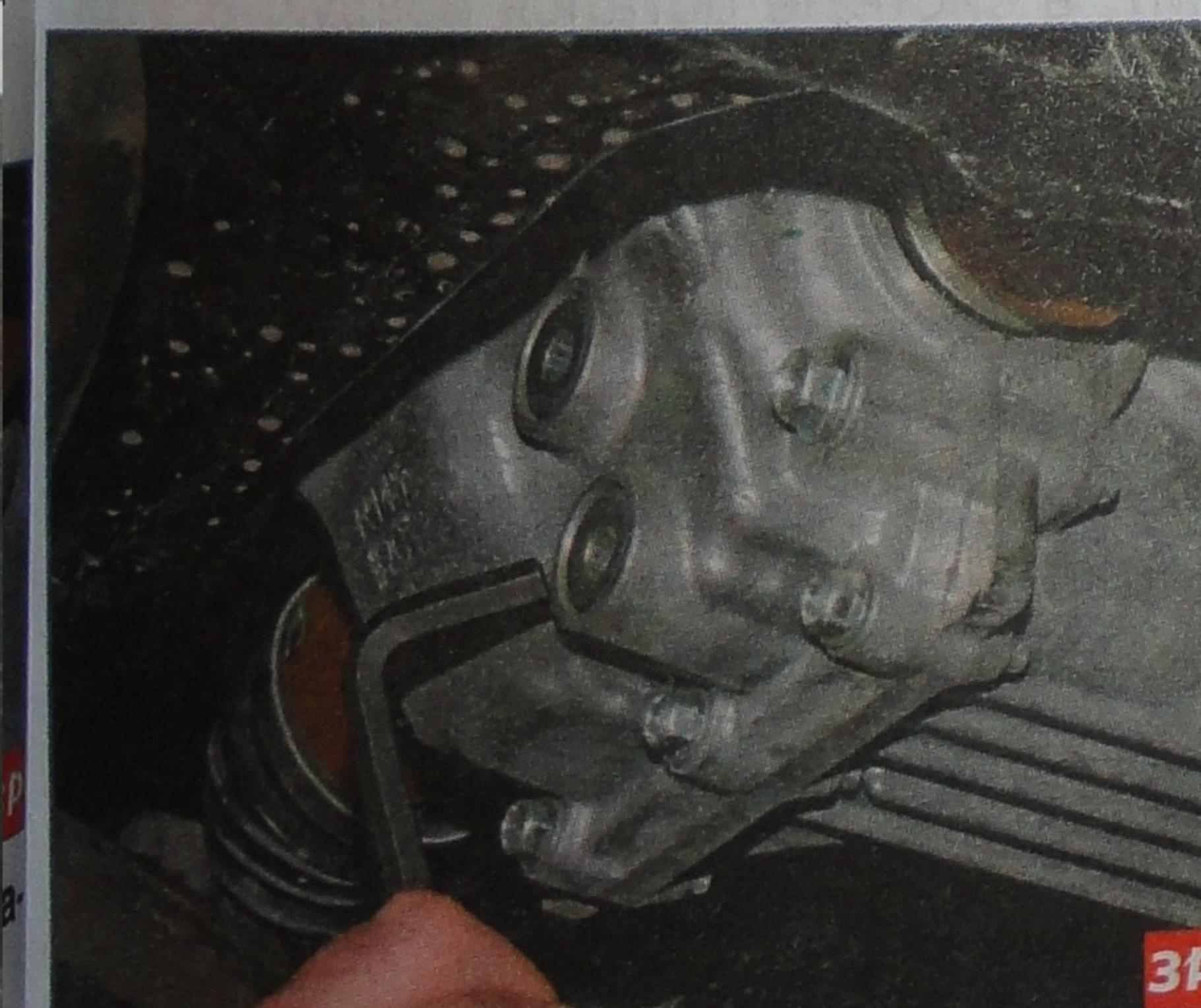
Шестигранником «на 10» отворачиваем пробку сливного отверстия...
