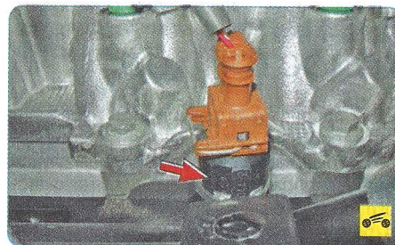
– датчик детонации (установлен с правой стороны блока цилиндров в районе 2-го и 3-го цилиндров) – двигатель очень чувствителен к качеству бензина, повышенная склонность к детонации;
