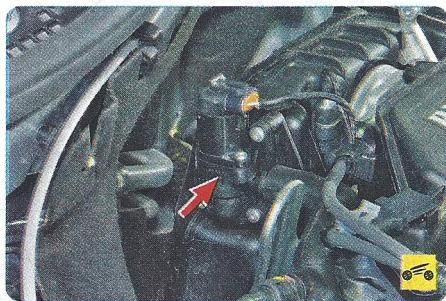
Однако необходимо отметить, что на автомобилях с двигателем K4M эта неисправность чаще всего бывает вызвана отказом регулятора холостого хода (см. «Система питания», с. 103) или подсосом постороннего воздуха через неплотные соединения шлангов, присоединенных к впускной трубе. Если заменой регулятора и подтяжкой хомутов шлангов восстановить холостой ход не удалось, обратитесь к специалистам.
