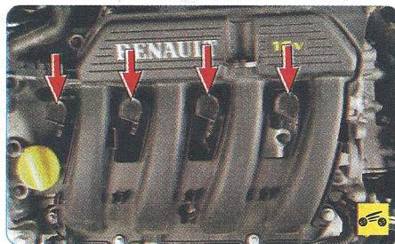
2. Если хлопки нерегулярны, остановите двигатель и откройте капот. Проверьте катушки зажигания и снимите катушку зажигания 1-го цилиндра со свечи (см. «Снятие и установка катушек зажигания», с. 213).
