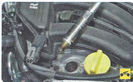
3. Выверните свечи свечным ключом (см. «Замена и обслуживание свечей зажигания», с. 213).
