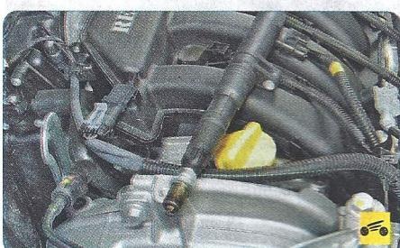
6. Проверьте катушки зажигания, установив в катушку проверенную свечу с «рабочей» машины. Вставьте в наконечник провода запасную свечу зажигания и прижмите ее к металлической части двигателя. Попросите помощника провернуть стартером коленчатый вал двигателя. В случае неисправности замените катушку зажигания (см. «Снятие и установка катушек зажигания», с. 213). Последовательно повторяйте эту процедуру со всеми цилиндрами, чтобы обнаружить неисправную катушку.
