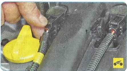
– проверьте посадку катушек зажигания на свечах и надежность присоединения к катушкам колодок жгутов проводов;
