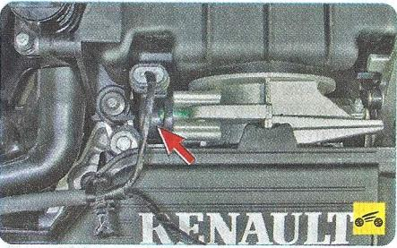
Специфической причиной рывков при установившемся движении автомобиля с инжекторным двигателем может быть выход из строя датчика положения дроссельной заслонки. Дополнительными симптомами, подтверждающими неисправность этого датчика, являются:
