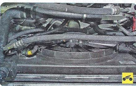
5. Очень часто причиной перегрева двигателя, система охлаждения которого оснащена электрическим вентилятором, является выход из строя электродвигателя вентилятора.
