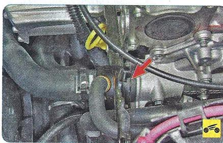
4. Двигатель может перегреться в случае выхода из строя термостата, который регулирует прохождение потока жидкости в системе охлаждения через радиатор или мимо него (для ускорения прогрева холодного двигателя). Для проверки термостата нужно на прогретом двигателе проверить на ощупь температуру нижнего шланга, соединяющего радиатор с двигателем. Если нижний шланг радиатора холодный, термостат неисправен, циркуляции через радиатор нет.
