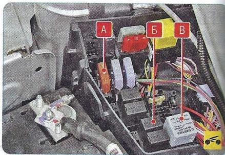
7. Замените предохранитель А в монтажном блоке, установленном в подкапотном пространстве. Если вентилятор после замены предохранителя так и не начал работать, замените реле Б и В в этом же монтажном блоке. Если после замены предохранителя и реле вентилятор не начал работать, проверьте электродвигатель, для чего возьмите два дополнительных провода и подайте на него питание непосредственно от аккумуляторной батареи. Провода должны быть надежно закреплены и изолированы.
