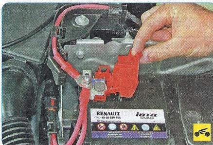
4. Откиньте защитную крышку клеммы «плюс» аккумуляторной батареи.
