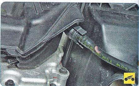
2. Если педаль осталась неподвижной, проверьте целостность и надежность соединения шланга вакуумного усилителя со штуцером на впускной трубе двигателя...
