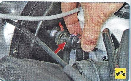
3. ...и с усилителем. Неисправный шланг замените или отремонтируйте. Если шланг исправен, необходимо заменить вакуумный усилитель (см. «Замена вакуумного усилителя», с. 188).
