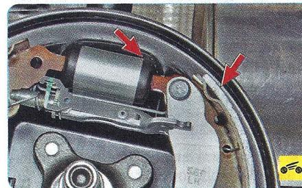
7. Проверьте подвижность поршней рабочего цилиндра заднего тормозного механизма. Для этого попробуйте сдвинуть с места поршни, сдавив тормозные колодки. Если сдвинуть поршни не удается, значит, их заклинило в тормозном цилиндре.
