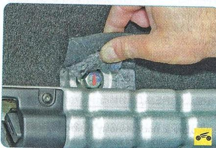
5. Для снятия запасного колеса на автомобиле с передним приводом отогните вырезанную часть напольного покрытия багажника.
