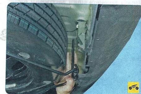
7. Немного приподнимите держатель запасного колеса и снимите его петлю с крючка кронштейна.
