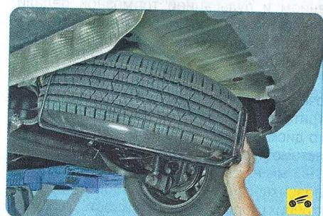
8. Опустите держатель вниз. Выньте запасное колесо из держателя и положите его под порог кузова рядом с заменяемым колесом.
