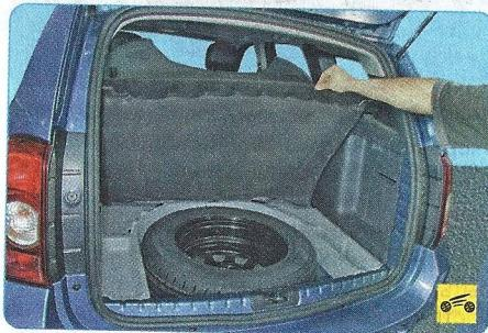
3. На автомобиле с полным приводом поднимите коврик пола багажного отделения...
