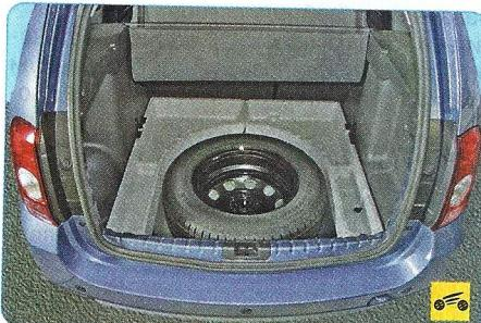
**Запасное колесо на автомобилях с полным приводом расположено в нише на полу багажного отделения...**
