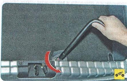
6. Используя баллонный ключ, выверните болт держателя запасного колеса на несколько оборотов против часовой стрелки (отворачивать болт полностью необязательно).
