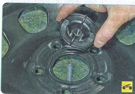
4. ...отверните пластиковую гайку и выньте запасное колесо из ниши.
