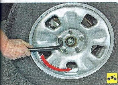
13. Слегка приподнимите автомобиль домкратом так, чтобы колесо, требующее замены, не отрывалось от дороги. Ослабьте баллонным ключом пять болтов крепления колеса.
