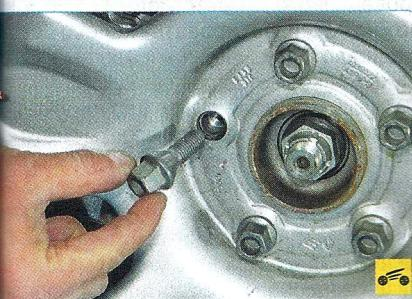
14. Поднимите домкратом автомобиль так, чтобы колесо оторвалось от дороги, после чего полностью выверните болты и снимите колесо.
