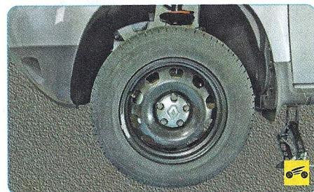
15. Установите запасное колесо вместо снятого, вверните крепежные болты до упора, но не затягивайте их.
