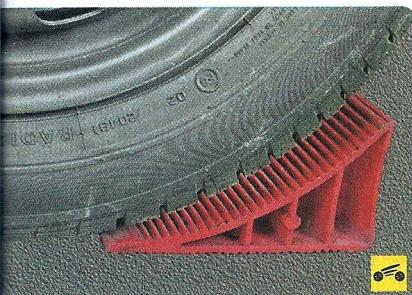
12. Автомобиль с противоположной стороны нужно зафиксировать, подложив под переднее и заднее колеса противооткатные упоры так, чтобы поднятый автомобиль мог сместиться вперед или назад.
