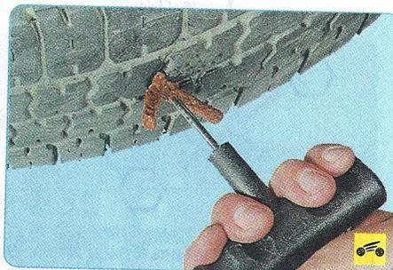
10. Нажатием на рукоятку иглы протолкните жгут в отверстие так, чтобы снаружи
