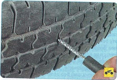
3. Обработайте рашпилем внутреннюю поверхность отверстия. После обработки поверхность будет очищена от грязи, ржавчины и ее края будут ровными.
