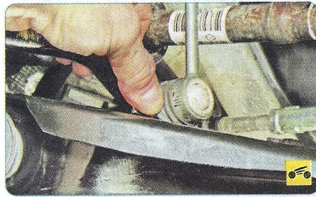
7. ...и нижнем шарнирах стойки стабилизатора поперечной устойчивости. Стойку, шарниры которой имеют ощущимый люфт, замените.
