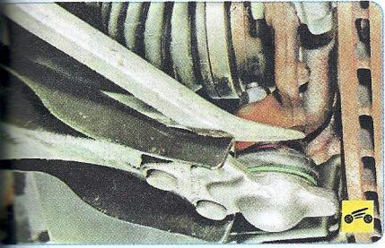
2. Проверьте шаровые опоры на наличие люфтов. Для этого вставьте монтажную лопатку между поворотным кулаком и рычагом подвески и, опираясь на рычаг, попытайтесь покачать поворотный кулак.
