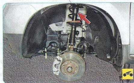
9. Проверьте состояние защитного чехла амортизаторной стойки.
