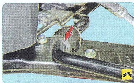
8. Проверьте состояние резиновых подушек в местах крепления штанги стабилизатора поперечной устойчивости к подрамнику передней подвески.
