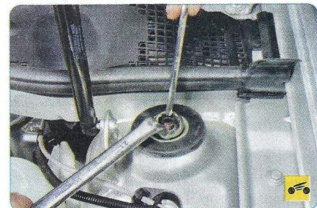
4. Удерживая одним ключом шток амортизатора от проворачивания, вторым ключом ослабьте затяжку гайки верхнего крепления амортизаторной стойки.
