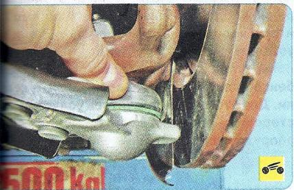
1. Проверьте состояние защитных чехлов шаровых опор. Если чехлы повреждены, замените шаровые опоры в сборе.
