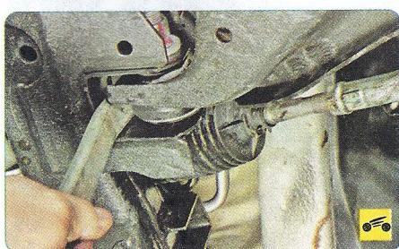
5. ...и заднего крепления рычага к подрамнику передней подвески.
