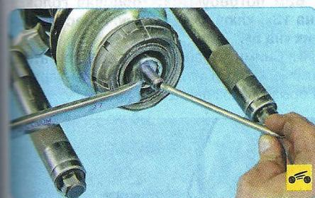
5. Отверните гайку штока, удерживая шток от проворачивания вторым ключом...
