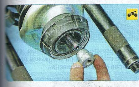
12. Установите амортизатор вертикально и несколько раз до упора опустите, и поднимите шток амортизатора. Убедитесь, что шток перемещается без провалов, заеданий и стуков. В противном случае замените амортизатор. Кроме того, замените амортизатор при обнаружении потеков жидкости (допускается незначительное отпотевание в верхней части корпуса) и при повреждении резьбы в верхней части штока.
