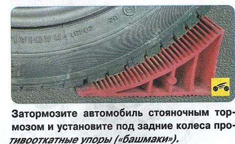
Затормозите автомобиль стояночным тормозом и установите под задние колеса противооткатные упоры («башмаки»).
