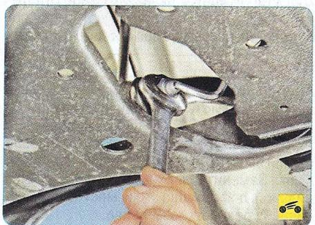
4. Отверните гайку крепления стойки к штанге стабилизатора удерживая палец шарнира от проворачивания.
