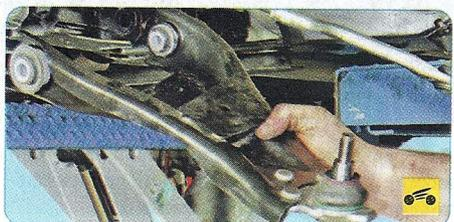
7. Снимите рычаг передней подвески.
