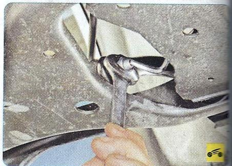
2. Отверните гайки крепления стоек к штанге стабилизатора удерживая пальцы шарниров от проворачивания.
