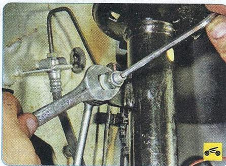
2. Отверните гайку крепления стойки стабилизатора поперечной устойчивости к кронштейну амортизаторной стойки, удерживая палец шарнира от проворачивания.
