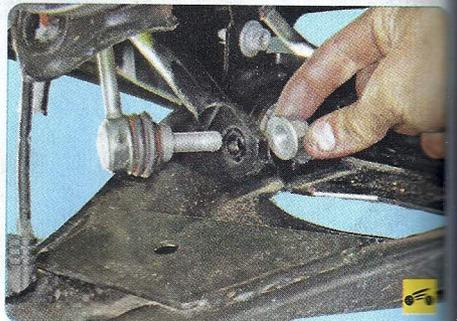
3. Извлеките пальцы нижних шарниров стоек стабилизатора из отверстий штанги.
