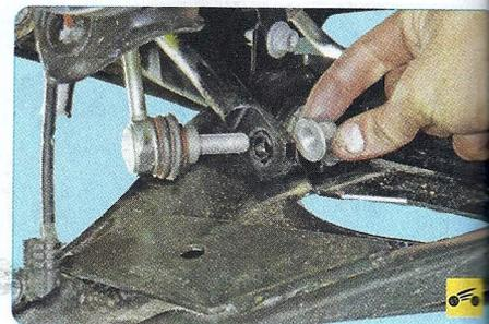
5. Извлеките палец нижнего шарнира стойки стабилизатора из отверстия штанги...
