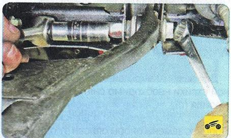
4. Отверните гайку болта крепления заднего сайлентблока рычага к подрамнику, удерживая болт от проворачивания...
