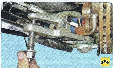
3. Установите съемник шаровых шарниров и выпрессуйте палец из рычага.
