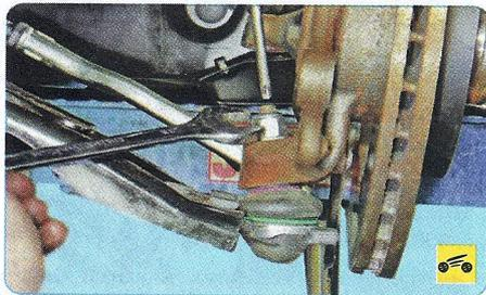
2. Отверните гайку крепления пальца шаровой опоры к поворотному кулаку, удерживая палец от проворачивания.
