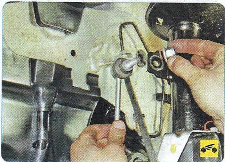
3. Извлеките палец верхнего шарнира стойки стабилизатора из кронштейна амортизаторной стойки.
