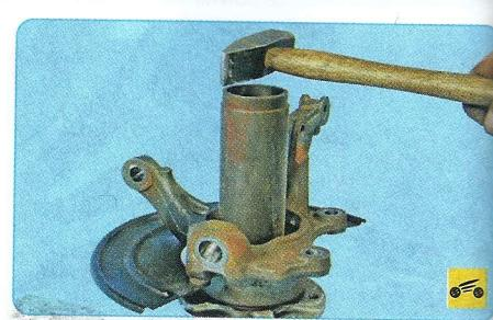
3. Зажмите поворотный кулак в тиски и выбейте ступицу молотком, используя оправку подходящего диаметра (например, торцовую головку).
