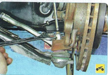
13. Отверните гайку крепления пальца шаровой опоры к поворотному кулаку, удерживая палец от проворачивания.
