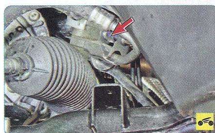
9. Отверните наконечники трубок гидросистемы гидроусилителя от рулевого механизма.
