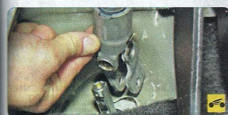
6. Отсоедините от рулевого механизма промежуточный вал рулевой колонки (см. «Снятие и установка рулевой колонки», с. 172).
