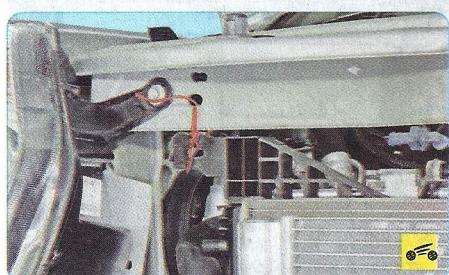
13. Закрепите проволокой радиатор системы охлаждения на верхней поперечине рамки радиатора.
