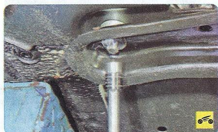
15. Выверните болты крепления усилителя кузова...
