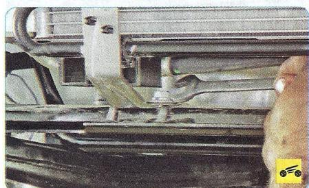
14. Выверните болты крепления кронштейнов нижнего крепления теплообменника гидроусилителя рулевого управления.
