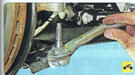
4. Отверните гайку и извлеките палец шарового шарнира наконечника рулевой тяги из бобышки поворотного кулака (см. «Замена наружного наконечника рулевой тяги», с. 173).
