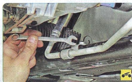
10. Выверните болт крепления держателя трубы гидроусилителя рулевого управления к подрамнику.
