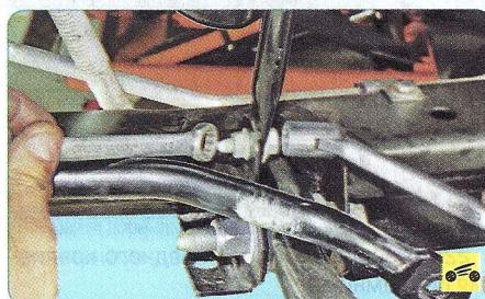
7. Отверните гайку болта крепления соединительной тяги к подрамнику...
