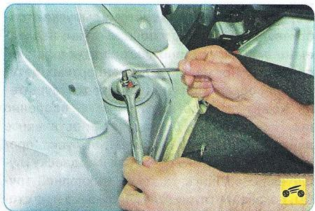
3. Отверните гайку крепления штока амортизатора, удерживая шток от проворачивания вторым ключом.
