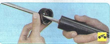
13. Снимите защитный колпачок.
