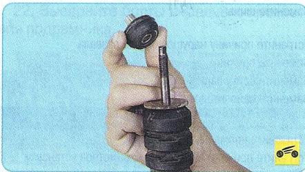
8. Снимите со штока амортизатора нижнюю резиновую подушку в сборе с распорной втулкой.
