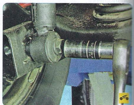
2. Выверните болт крепления амортизатора к рычагу задней подвески.
