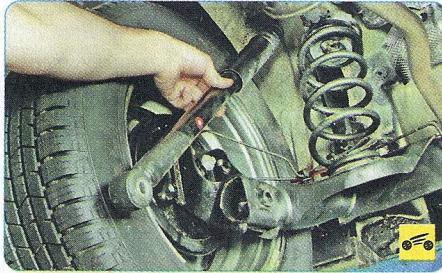
7. Снимите амортизатор с автомобиля.
