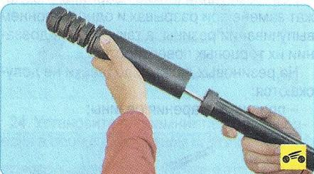
11. Снимите со штока амортизатора буфер сжатия в сборе с защитным чехлом.
