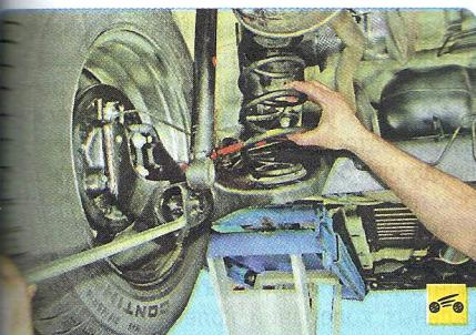
3. При помощи монтажной лопатки отожмите продольный рычаг задней подвески вниз...
