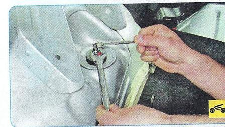
4. Отверните гайку крепления штока амортизатора, удерживая шток от проворачивания вторым ключом.
