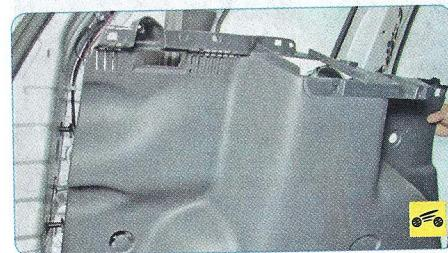
3. Снимите нижнюю обивку боковины кузова (см. «Снятие и установка облицовок багажного отделения», с. 280).
