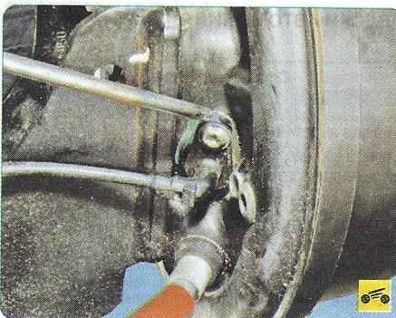
6. Выверните болт крепления датчика частоты вращения колеса...
