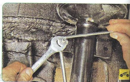
2. Отверните гайку крепления стойки стабилизатора поперечной устойчивости к кронштейну амортизаторной стойки, удерживая палец шарнира от проворачивания и извлеките палец из отверстия кронштейна.
