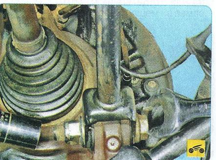
5. ...и передний поперечный рычаги задней подвески.
