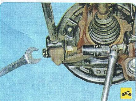
3. Отверните гайку болта крепления заднего поперечного рычага к кулаку, извлеките болт из проушин тяги и кулака и отсоедините рычаг.
