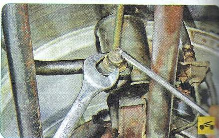
3. Отверните гайку крепления стойки к штанге стабилизатора удерживая палец шарнира от проворачивания и извлеките палец из отверстия штанги.
