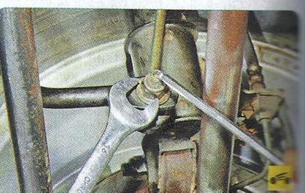
2. Отверните гайки крепления стоек к штанге стабилизатора удерживая пальцы шарниров от проворачивания и извлеките пальцы из отверстий штанги.
