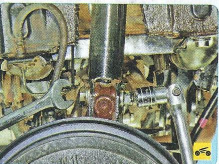
9. Отверните гайки болтов крепления поворотного кулака к амортизаторной стойке и извлеките болты.
