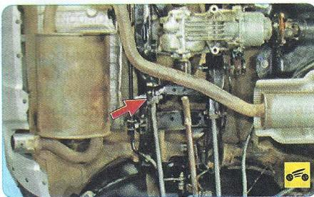
4. Аналогично отсоедините рычаг от подрамника и снимите рычаг.
