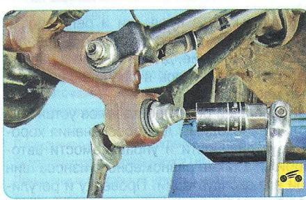
5. Отверните гайку болта крепления продольного рычага к кулаку, извлеките болт из проушин рычага и кулака и отсоедините рычаг.
