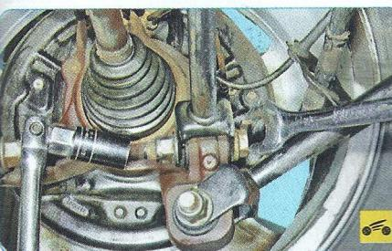
3. Отверните гайку болта крепления переднего поперечного рычага к кулаку, извлеките болт из проушин рычага и кулака и отсоедините рычаг.
