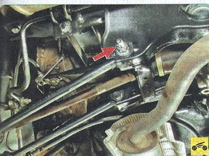
2. Аналогично отсоедините рычаг от подрамника и снимите рычаг.
