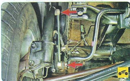
2. Отверните гайки болтов крепления поперечных рычагов к подрамнику задней подвески, извлеките болты из проушин рычагов и подрамника и отсоедините рычаги.
