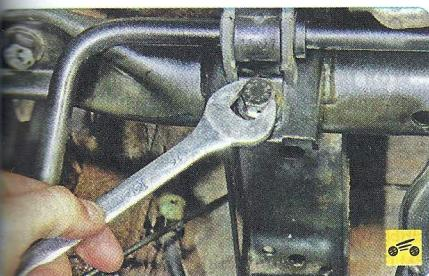
3. Выверните по одному болту крепления скоб штанги стабилизатора к подрамнику и снимите штангу.
