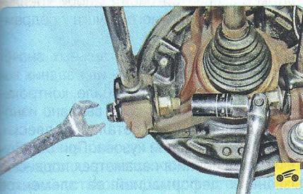
1. Отверните гайку болта крепления заднего поперечного рычага к кулаку, извлеките болт из проушин рычага и кулака и отсоедините рычаг.
