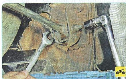
3. Выверните по два болта крепления подрамника к кузову с обеих сторон и снимите подрамник.
