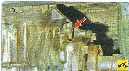
1. Для проверки уровня масла выверните пробку контрольного отверстия раздаточной коробки, расположенного на ее картере справа по направлению движения автомобиля. Уровень масла должен быть у кромки контрольного отверстия или чуть ниже (можно достать до поверхности масла пальцем).
