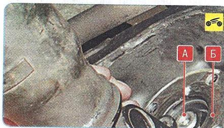
3. Отверните гайку А крепления фланца Б ведомого вала раздаточной коробки и снимите фланец с хвостовика вала.
