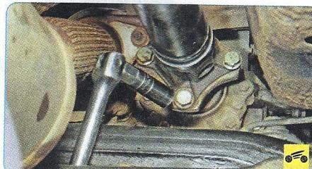
2. Отсоедините от фланца ведомого вала фланцевую вилку переднего карданного шарнира, вывернув четыре болта ее крепления, и отведите вал в сторону (см. «Снятие и установка карданной передачи», с. 141).
