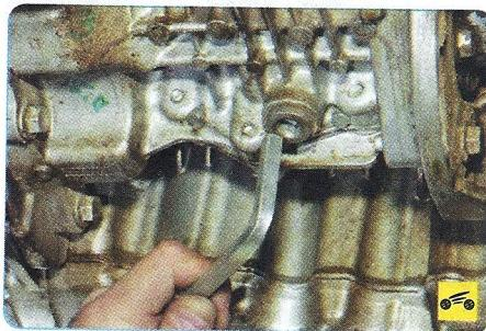
4. Для замены масла в раздаточной коробке выверните пробку сливного отверстия (расположена снизу на картере раздаточной коробки), предварительно подставив под него емкость для слива масла, и слейте масло.
