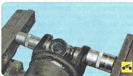
4. Выпрессуйте одновременно два противоположных подшипника крестовины из проушин (один подшипник выпрессовывается наружу, а другой – внутрь вилки), подбрав из торцевых головок комплекта инструментов подходящие по размеру для использования, как упорное кольцо и оправка, и снимите их. При выпрессовке обратите внимание на то, чтобы инструмент, используемый в качестве оправки, не повредил пресс-масленку, ввернутую в крестовину.
