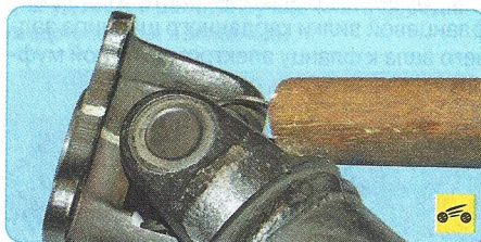
Рис. 6.8. Схема запрессовки подшипников карданного шарнира
