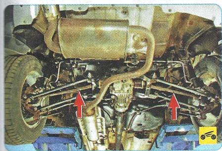
От полусовесовых шестерен редуктора крутящий момент передается к задним колесам с помощью приводов, по конструкции практически полностью аналогичных приводам передних колес и отличающихся от них только длиной валов.
