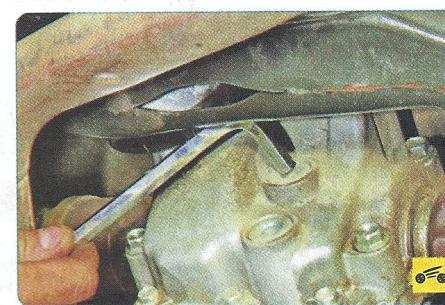
1. Для проверки уровня масла выверните пробку контрольного отверстия редуктора заднего моста, расположенного на задней
