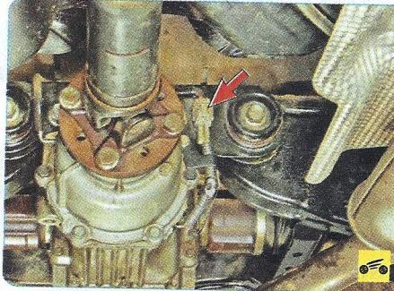
1. Разъедините колодку жгута проводов электромагнитной муфты, скав фиксаторы ее крепления, и отведите жгут в сторону.
