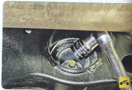
8. Отверните гайку крепления редуктора заднего моста к задней подушке подвески редуктора к подрамнику.
