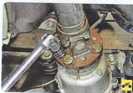
3. Выверните четыре болта крепления фланцевой вилки карданного шарнира к фланцу редуктора заднего моста.
