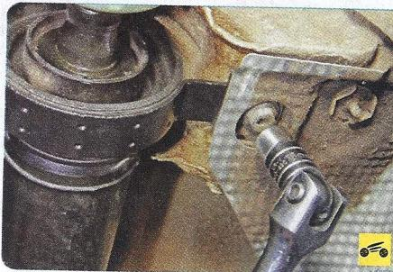
4. Придерживая карданную передачу, выверните два болта крепления промежуточной опоры к основанию кузова и отсоедините карданную передачу от фланца редуктора заднего моста. Отведите карданную передачу в сторону, не отсоединяя ее передний вал от раздаточной коробки.
