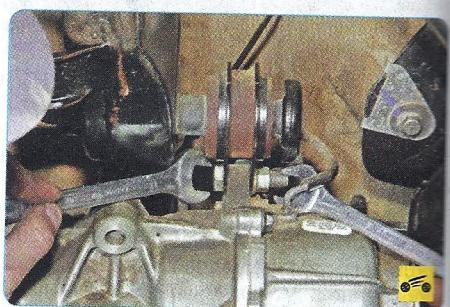
9. Отверните гайки болтов крепления кронштейнов двух передних подушек подвески редуктора к картеру редуктора, извлеките болты из отверстий картера и кронштейнов и снимите редуктор.
