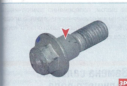
Болт крепления кронштейна к блоку цилиндров и поддону картера двигателя с центрирующим пояском
