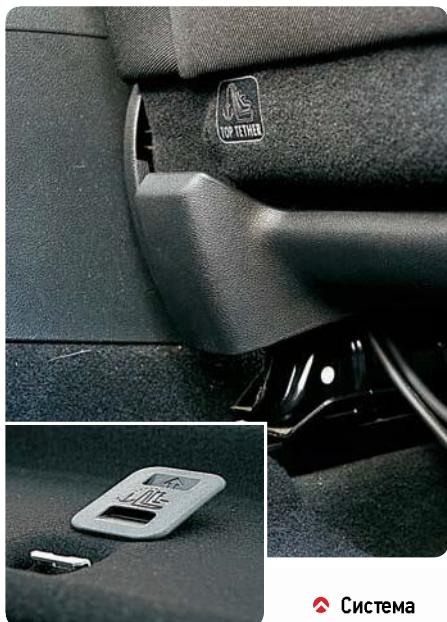
Система крепления «топ тезер» фиксирует верхнюю часть детского кресла дополнительным ремнем, пристегивающимся к проушине в багажнике или на спинке сиденья. Она служит дополнением к «изофиксу» и предотвращает переворот кресла при ударе. Варианты креплений на переднем сиденье «Пежо-308» (вверху) и заднем «Лады-Гранта».
