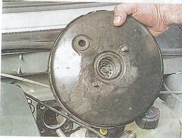
12. Устанавливаем вакуумный усилитель тормозов в обратной последовательности. Шумоизоляционную обивку крепим держателями.
