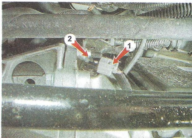
5. Проверяем состояние выводов колодки жгута проводов. При обнаружении на них окислов обрабатываем выводы средством для защиты и очистки электрических контактов.
