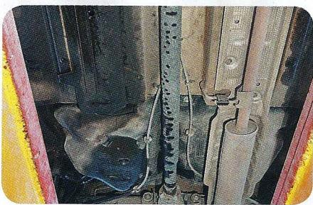
Наиболее уязвимый элемент в пределах колесной базы — выхлопная магистраль
