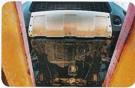
Снизу силовой агрегат надежно защищен. Но «пасть» в бампере вызывает опасения
