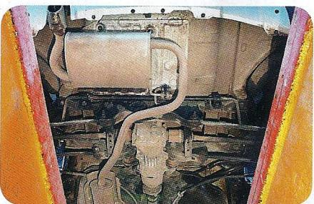
Глушитель в углублении бампера почти не искашает геометрическую проходимость
