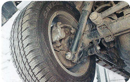
Низкие крепления амортизаторов могут «стопорить» автомобиль на бездорожье
