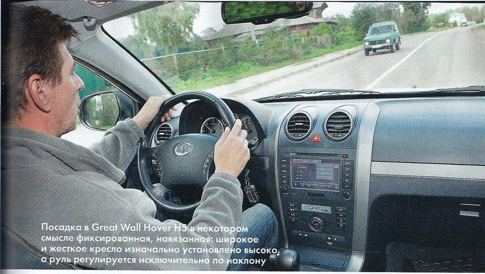
Посадка в Great Wall Hover H5 в некотором смысле фиксированная, навязанная: широкое и жесткое кресло изначально установлено высоко, а руль регулируется исключительно по наклону
