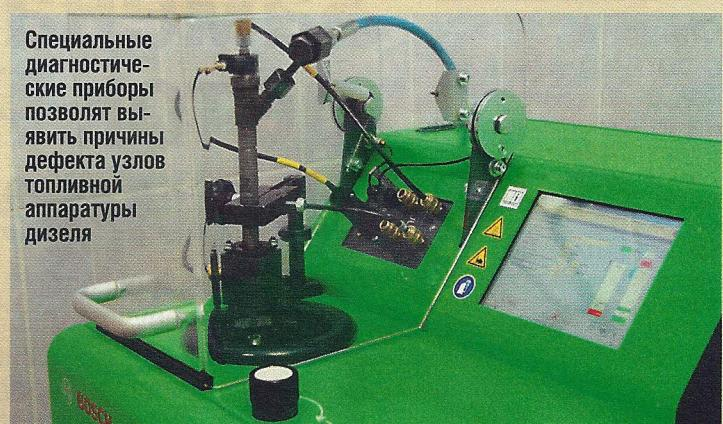
Дизельная аппаратура весьма привередлива к качеству топлива, и его несответствие требуемым показателям может вызвать перебои в работе силового агрегата. Так, например, применение солярки с плохой смазывающей способностью (обычно с малым содержанием серы) может вызвать преждевременный износ форсунок, плунжерных пар и других элементов системы питания дизеля. Это приводит к дефектам, которые дадут о себе знать увеличением шумности мотора и нередко появлением громких стуков.
