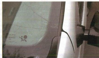
От удара кузов «сыграл», окончательно разрушив лобовое стекло
