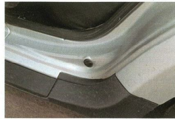
Вместо концевиков в проеме задних дверей стоят заглушки, поэтому при открытии дверей не включается свет в салоне, а система блокировки замков не понимает, что дверь открыта
