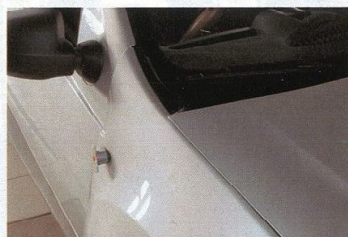
Хук слева! От удара вылетел правый повторитель указателя поворота, съехавший капот повредил не только левое, но и правое крыло, а само оно сместилось наружу
