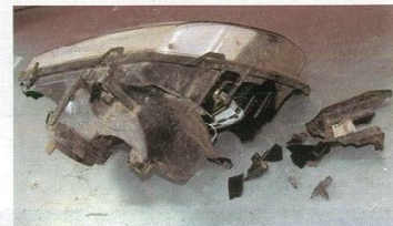
«Стекло» фары уцелело, но корпус из хрупкого пластика разлетелся на куски
