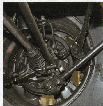
Тросы ручного тормоза перетерлись о кронштейн (показано стрелкой), но с июля изменилась и форма отверстия в кронштейне, и его положение на рычаге (на нижнем фото)
