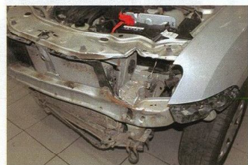
Зажатые передней поперечиной радиаторы, покоробленные верхняя панель, левые брызговики моторного отсека и крыло... Все то же самое, только с меньшей степенью деформации после аналогичного удара мы наблюдали и у Renault Sandero
