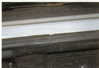
Концы уплотнителей дверных проемов не скреплены и едва держатся за порог — их легко сбить ногой при высадке
