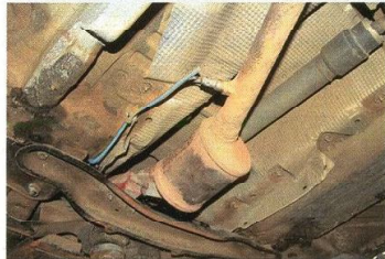
Удивительно, но уязвимо проложенная проводка кислородного датчика с небрежной изоляцией ничуть не пострадала
