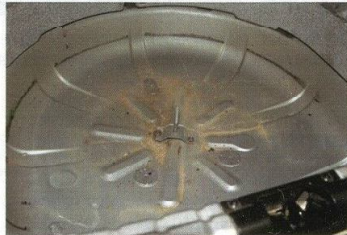
Отвалившийся по обоим местам точечной сварки кронштейн запаски мы на скорую руку закрепили болтами
