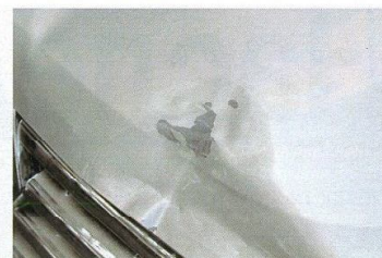
Все наружные панели сделаны из качественного оцинкованного проката (серое защитное покрытие видно на участке без краски), оттого в тарированных надрезах нет и следа коррозии
