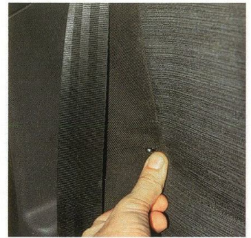
Острые выпирающие углы механизма складывания спинки проделали дырки в обивке заднего сиденья
