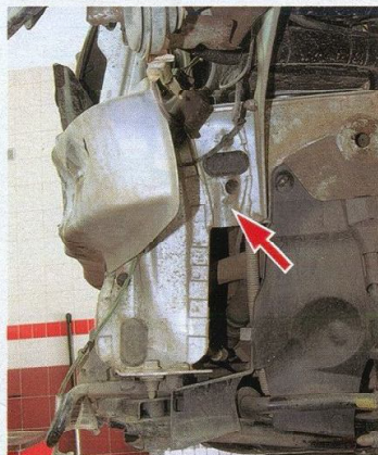
Наиболее неприятные последствия удара — деформация лонжерона (самая крупная складка показана стрелкой) и подрамника силового агрегата
