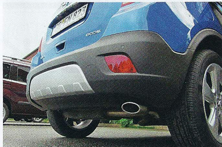
Сзади самая уязвимая точка — труба системы выхлопа и сама банка глушителя
